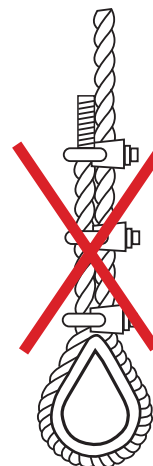
Abbildung 4: Seilklemme nach DIN 1142 (alt) oder DIN EN 13411-5
